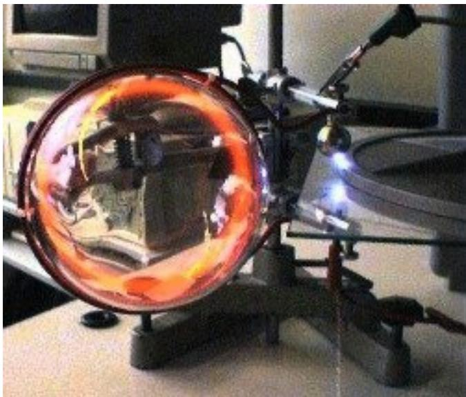
Abb. 37 Elektrodenlose Ringentladung in einer Anordnung nach NEVA. Der Versuch hat m.E. eine wesentliche Funktion für ein Verständnis der Induktion (= Entstehung eines elektrischen Wirbelfelds) und sollte in keinem Kurs über Induktion fehlen.
