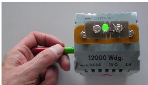
Abb. 41 Im Schülerversuch wird die Induktion entdeckt. Wie kann man die Zweifarben-LED zum roten oder grünen Leuchten bringen?
